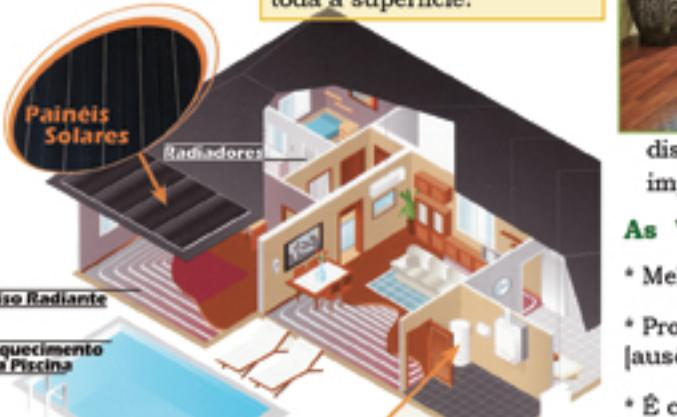
→ Água Quente Sanitária gerada pela Energia Solar através do painel e armazenada dentro do acumulador, sempre que o mesmo não consiga produzir calor suficiente acciona a caldeira que irá produzir a energia restante para produzir a temperatura desejada.
